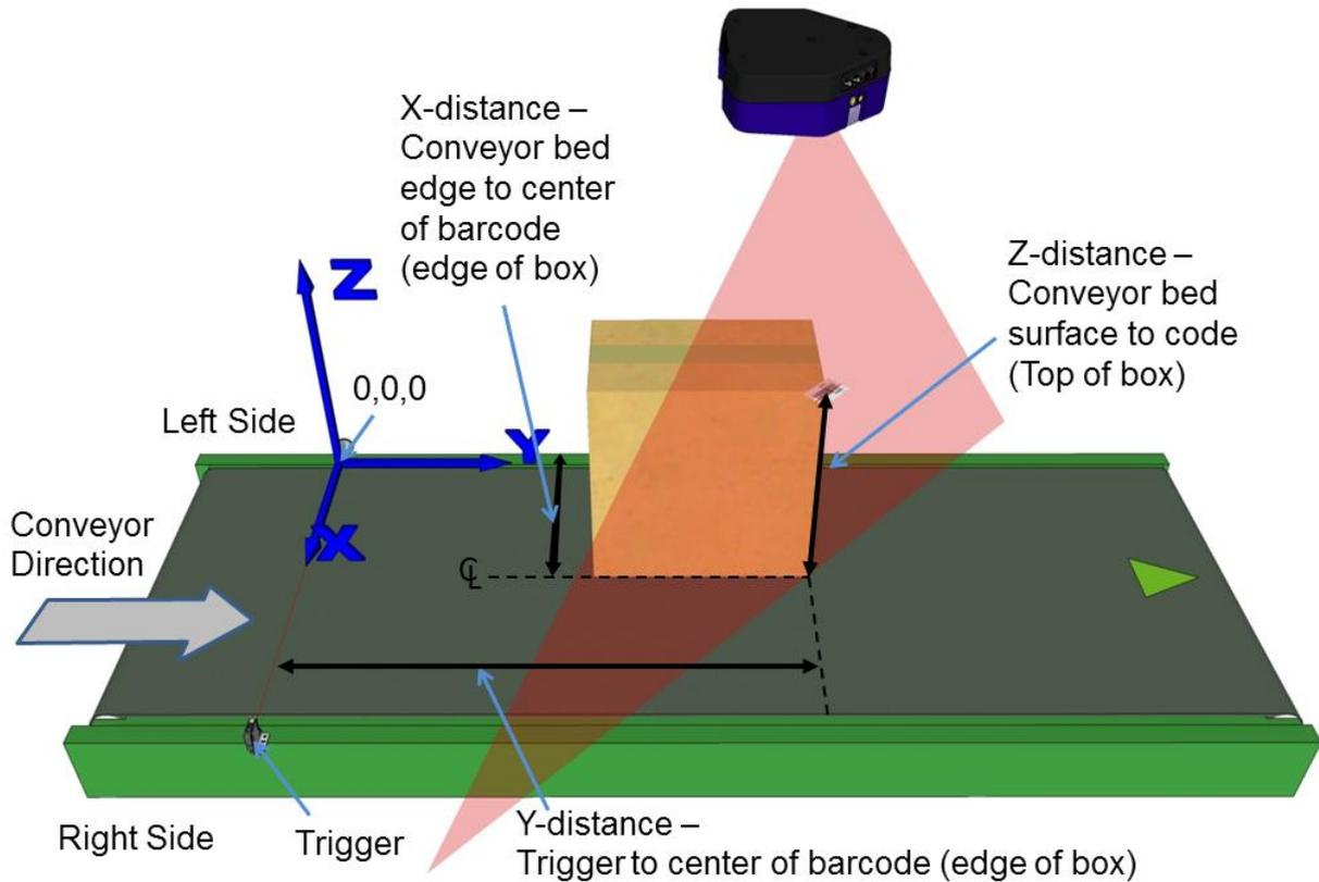
Figure 46: Top-read 3<sup>rd</sup> barcode placement
