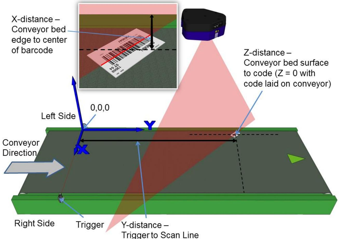
Figure 43: Top-read 1<sup>st</sup> barcode placement
